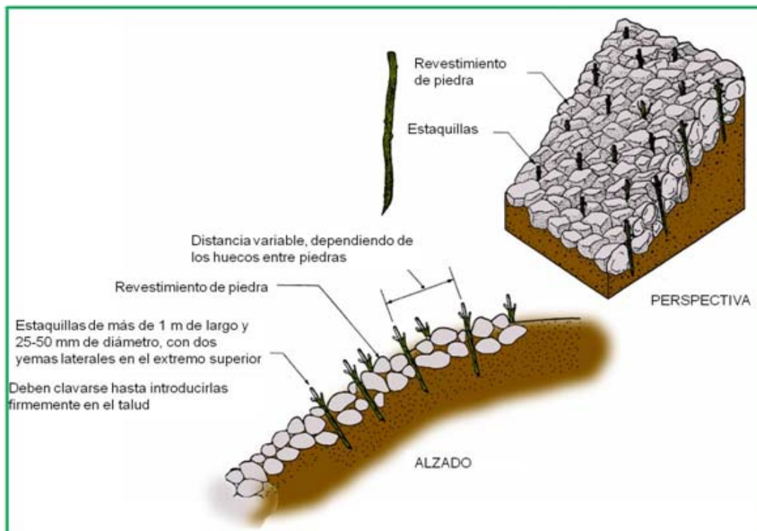
Fig. 45. Esquema de colocación de estaquillas en pedreras.
