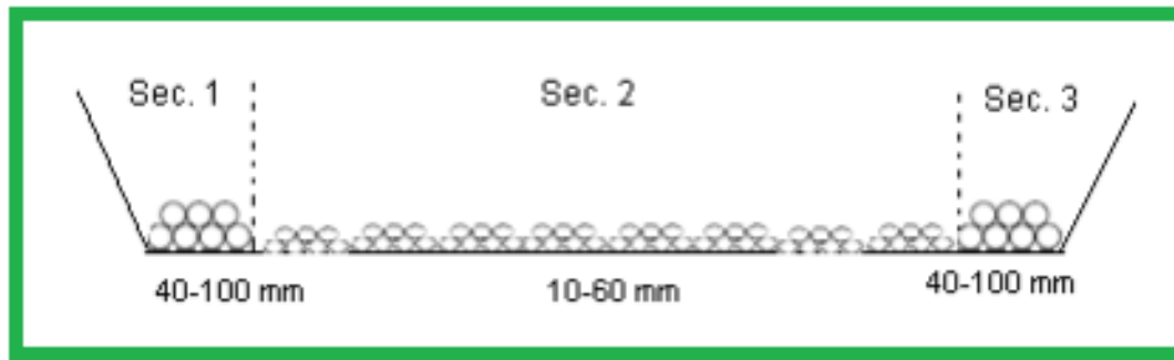
Fig. 23. Esquema de disposición de lecho en un humedal.
