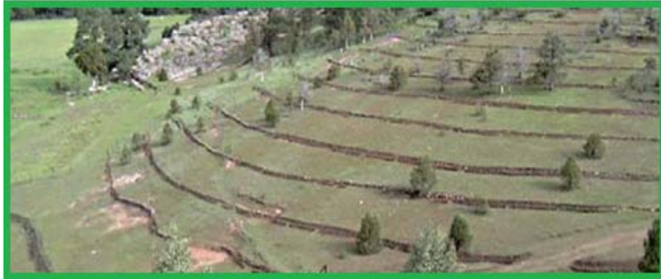
Fig. 17. Técnica de terraceo por formación sucesiva.
