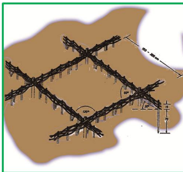
Fig. 38. Colocación en diagonal de empalizadas trenzadas.
