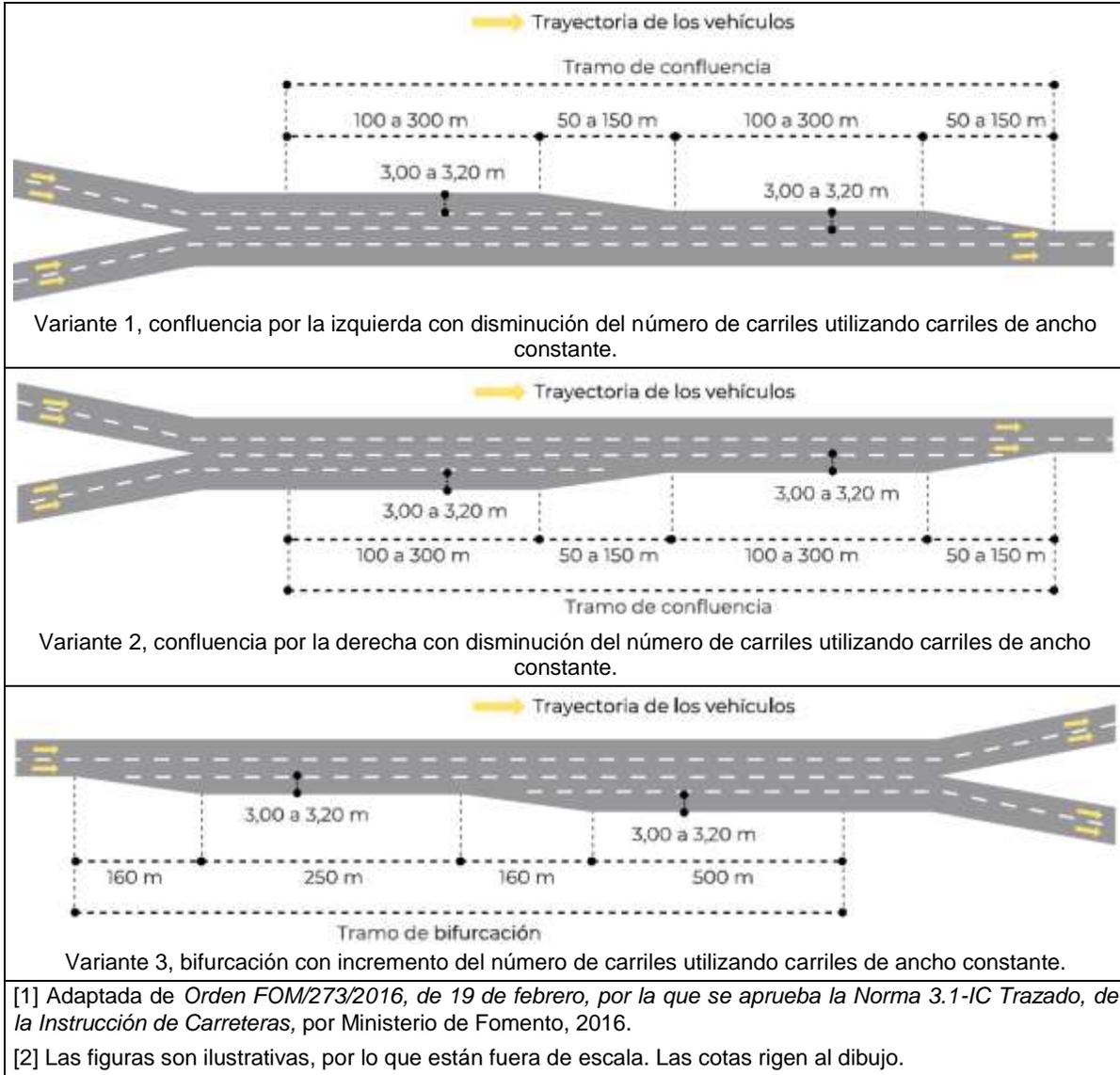
Carriles de confluencia o bifurcación de ancho variable: deben proporcionar una variación lineal del ancho de carril entre tres (3) y seis coma cuarenta (6,40) metros, como se muestra en las variantes de la figura 26.
