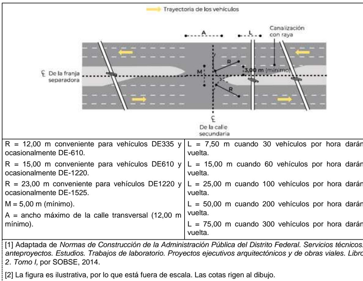
Los carriles de almacenamiento y espera deben tener un ancho entre tres (3) y tres coma veinte (3,20) metros y estar colocados en una alineación recta.
