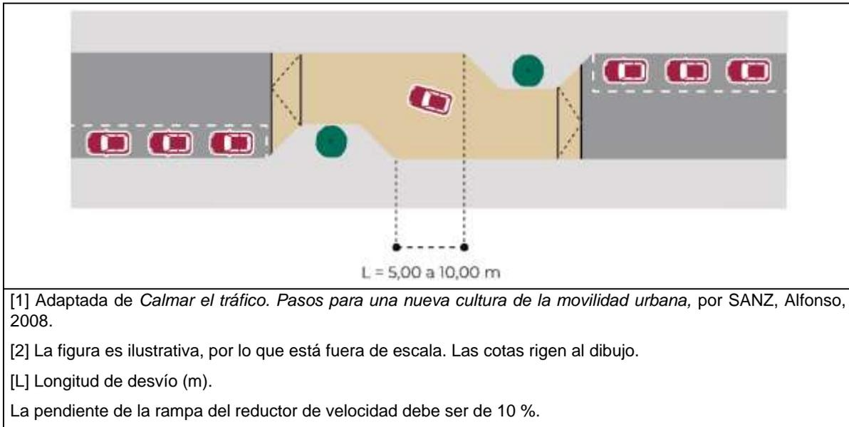
Se puede hacer una combinación de zigzag con estrechamiento, para calles bidireccionales, se recomienda un ancho en el arroyo vial de cinco (5) metros, con un ancho mínimo, en el punto más estrecho, de dos coma veinte (2,20) metros y, en caso de haber presencia de vehículos de carga, el ancho mínimo debe ser de dos coma cincuenta (2,50) metros, como se muestra en la figura 104.
