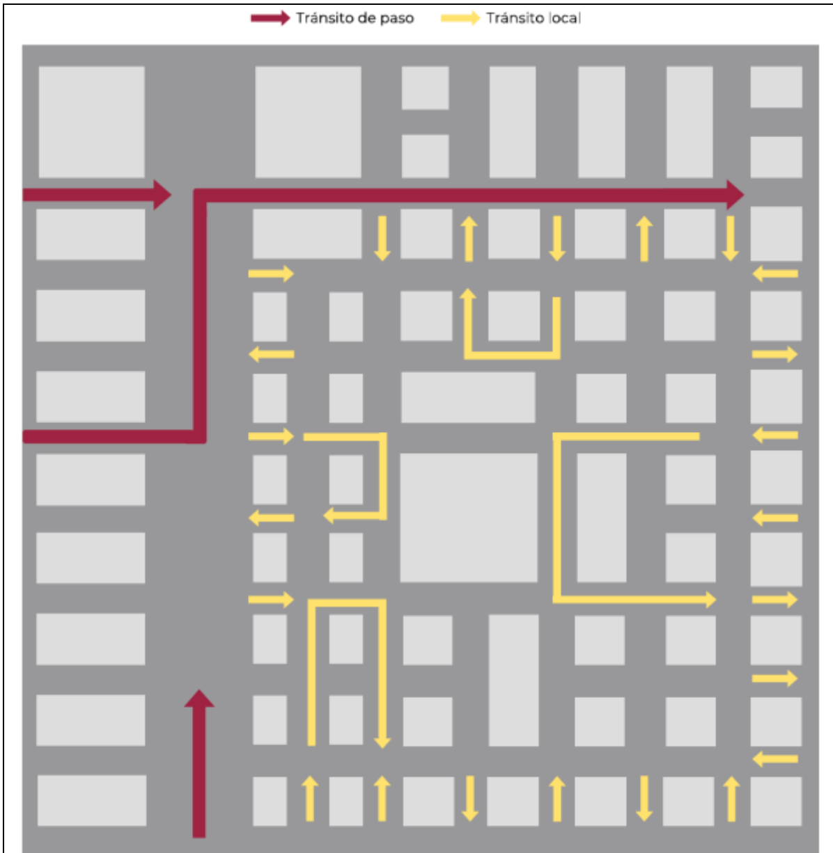
Figura 99.- Zona con sentidos encontrados [1] [2]
