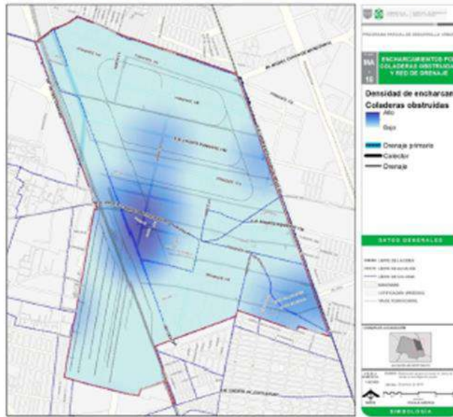
Imagen 24. Encharcamientos por coladeras obstruidas y red de drenaje
