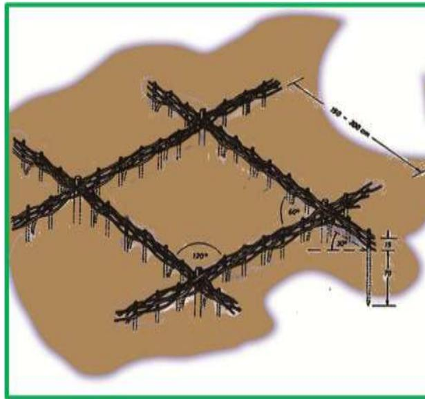
**Fig. 40.** Colocación en diagonal de empalizadas trenzadas.
