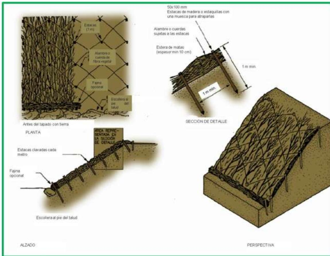
**Fig. 14.** esquema de instalación de las esteras marginales.
