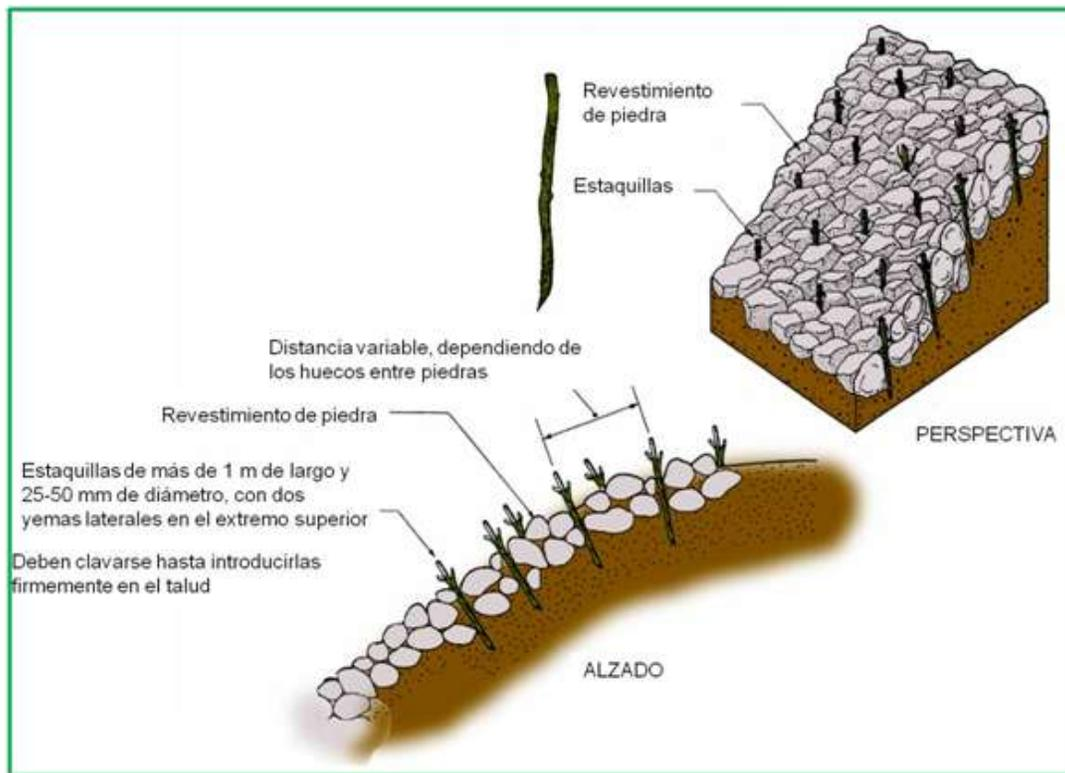
**Fig. 46.** Esquema de colocación de estaquillas en pedreras.
