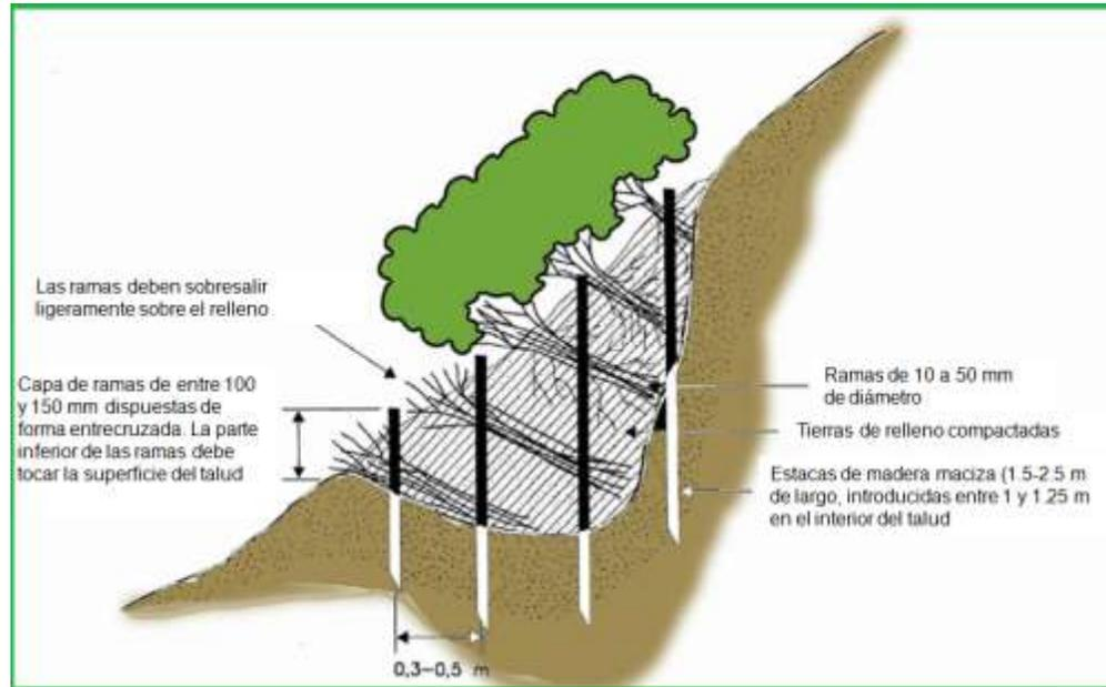
**Fig. 36.** Esquema de instalación de paquetes de matorral.
