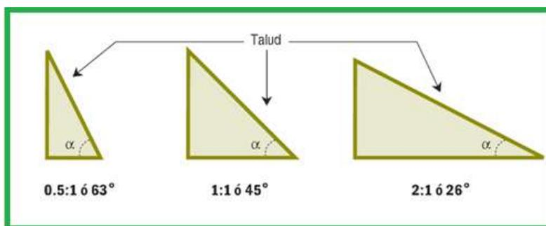
**Fig. 8.** Grados de inclinación para despalme de talud.
